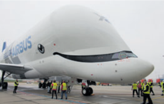
Die BelugaXL fliegt mit Trent 700-Triebwerken von Rolls-Royce. Das abge-senkte Cockpit, die Frachtraumstruktur sowie das Heck und Leitwerk wur-den gemeinsam mit Partnern entwickelt. Sie verleihen dem Flugzeug sein einzigartiges Aussehen. Foto: pm
