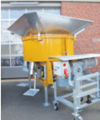
Jede der Sandsackfüllanlagen kann bis zu 3.800 Säcke in nur einer Stunde befüllen
