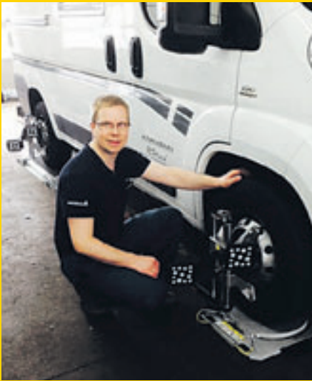
Thomas Lenke bei einer Achsvermessung an einem Wohnmobil.
